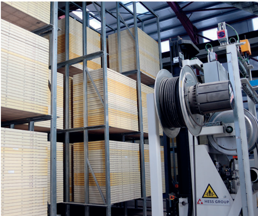
Der Brett-Puffer am Beginn der Nassseite nimmt 3.240 Produktionsunterlagen auf.
