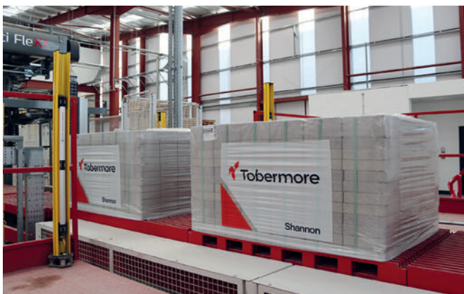
Steinpakete umreift, mit Stretch-Haube geschützt und mit dem Tobermore-Logo versehen – fertig für den Transport
