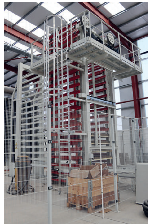
Sowohl hinter Hub- als auch hinter Senk-leiter gibt es je ein Pufferregal mit 17 Eta-gen Doppelstoß und 14 Tonnen Kapazität.
