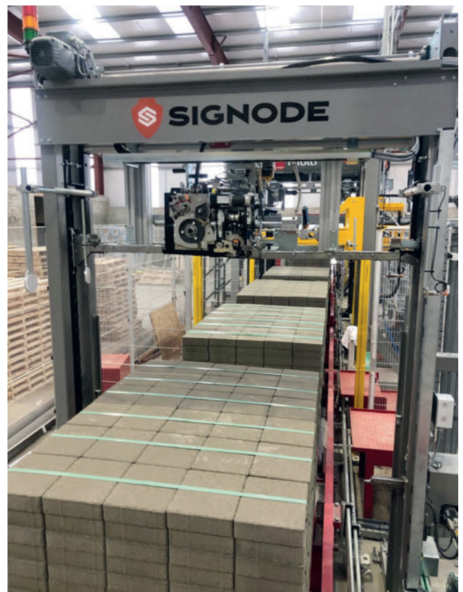
Die Umreifung erfolgt auf einer TSM-H6500-Maschine mit Jumbo Reel Dispenser und HSM-H3000-Aufsatz von Hersteller Signode.
