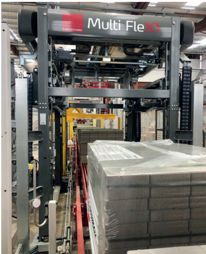
Nach dem Umreifen überzieht eine Multiflex1 Stretch Hooding-Maschine von Hersteller Lachenmeier die Steinpakete mit einer Stretchhaube.
