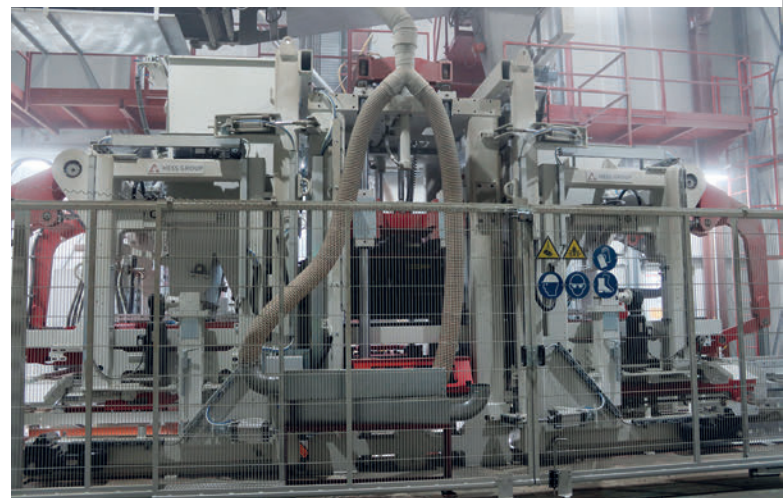
Der Steinfertiger Hess RH 1500-4 MVA ist das Herz der Produktion.
