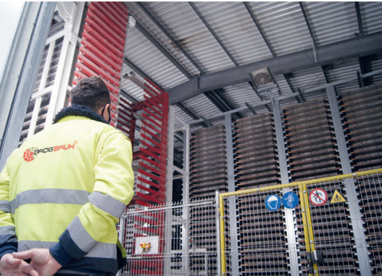
Опускной штабелер и транспортная группа расположены внутри однокамерной стеллажной установки Rotho с системой обогрева Pro Cure
