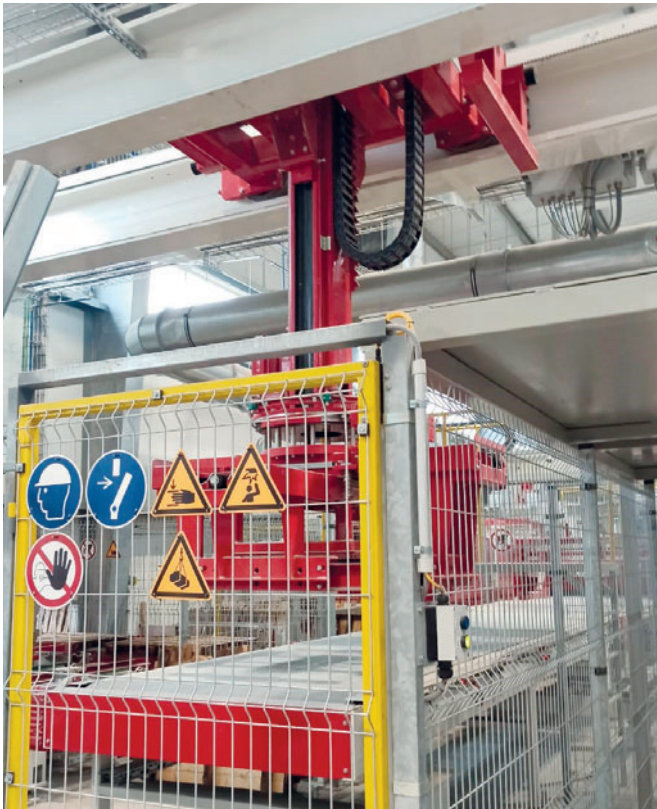
Штабелеукладчик с тележками с электромеханическим четырехсторонним захватом
