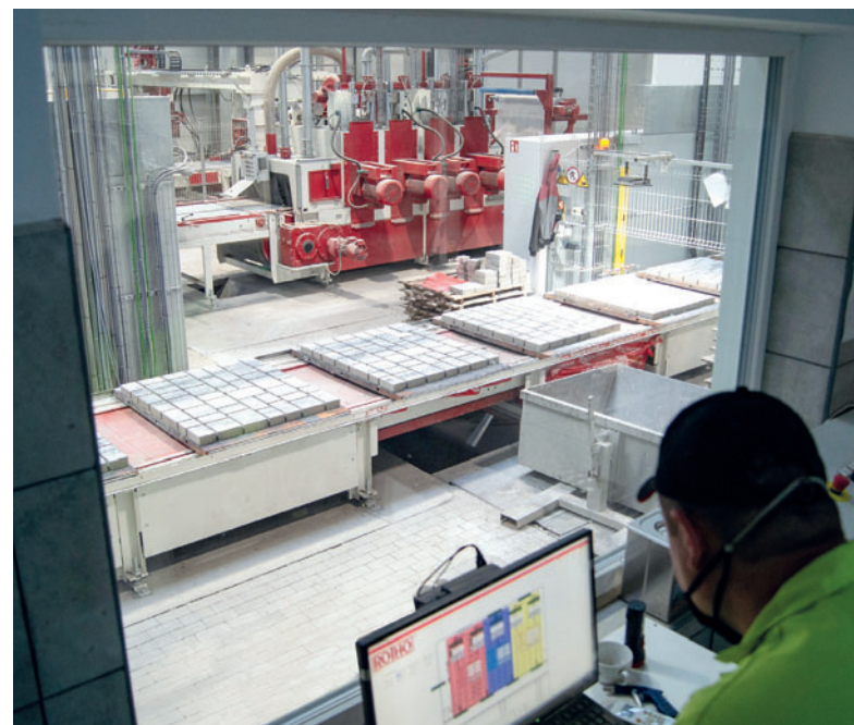
Пункт управления на сухой стороне, на заднем плане - установка полировки щетками SR Schindler
