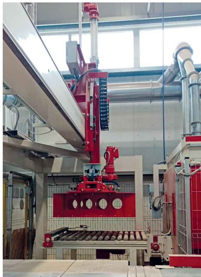
Dispositivo di movimentazione con pinza pneumatica a 2 lati
