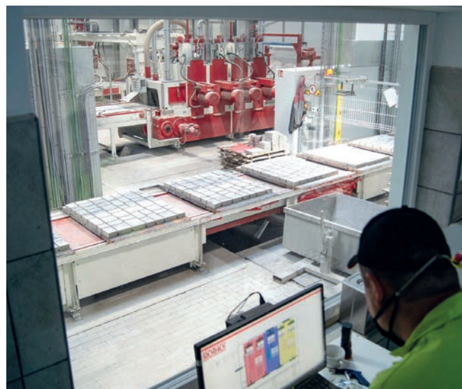
Uno sguardo dalla cabina di comando sulla linea del secco, sullo sfondo è situata la macchina per il curling di SR Schindler
