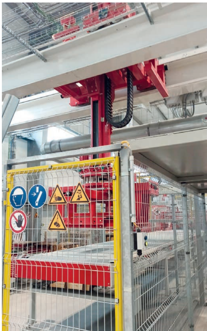
Impilatore strati con carrello con pinza motorizzata a 4 lati
