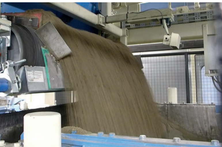
Riempimento del vagone di caricamento tramite nastro dosatore.
