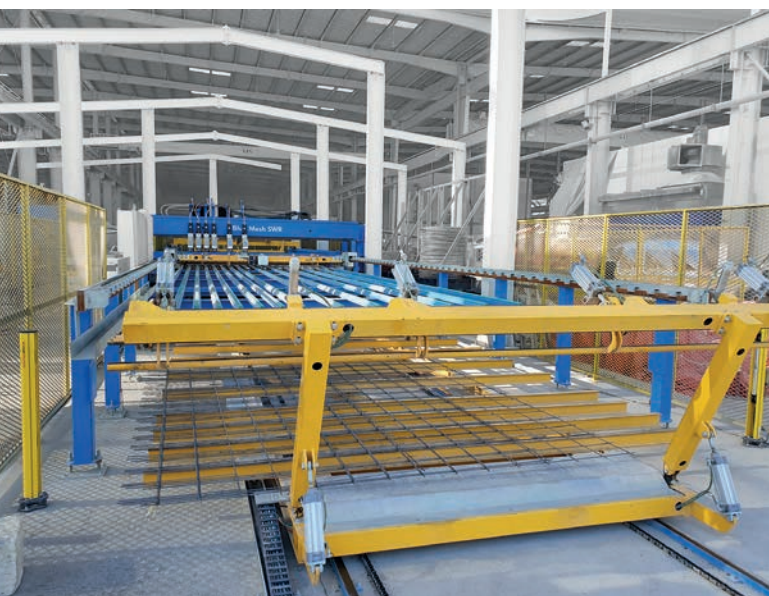
L'impianto di nuova concezione è progettato per la massima flessibilità nella produzione di reti.
