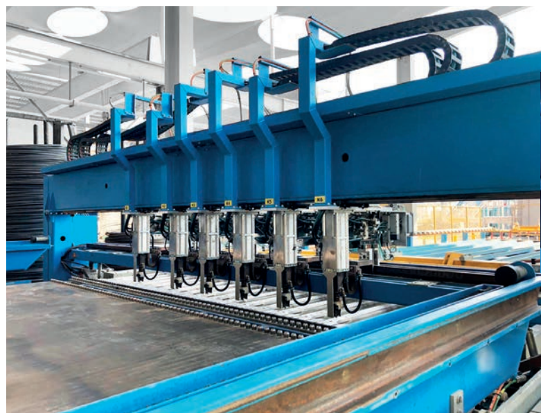
Le reti d'armatura sono prodotte sull'impianto di saldatura reti M-System BlueMesh®, precise e just in time.
