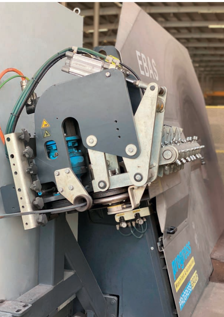
La staffatrice automatica EBA S 16 della Progress Maschinen & Automation lavora con successo l'acciaio d'armatura.
