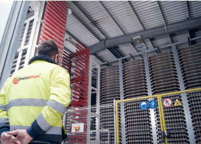
*Le descenseur et le chariot transbordeur sont situés à l'intérieur de la chambre de cure à racks de Rotho, équipée d'un système de chauffage Pro Cure*
