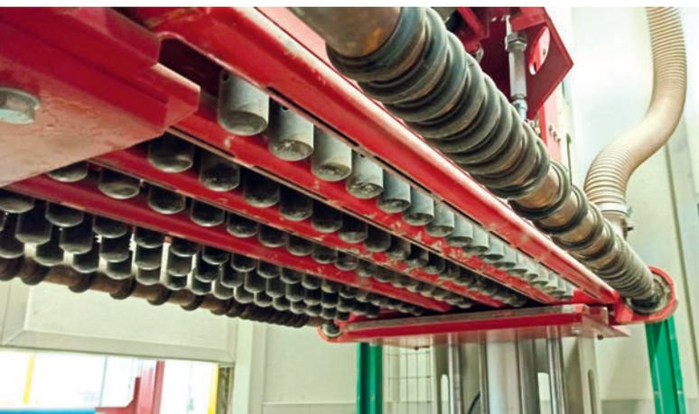
Support avec marteaux de bouchardage pour le vieillissement des pavés
