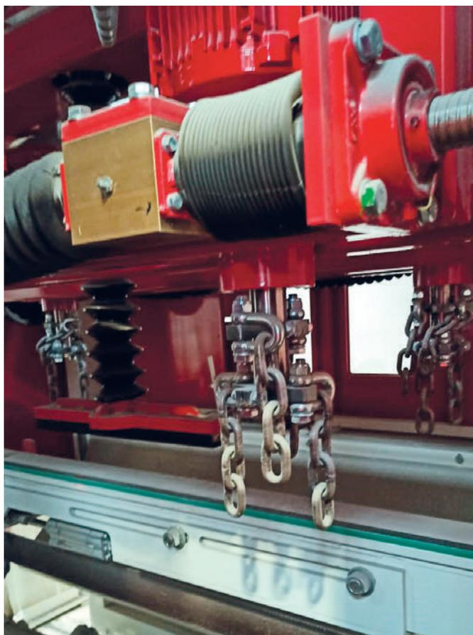
Supports d'impact à chaînes pour l'usinage des arêtes verticales
