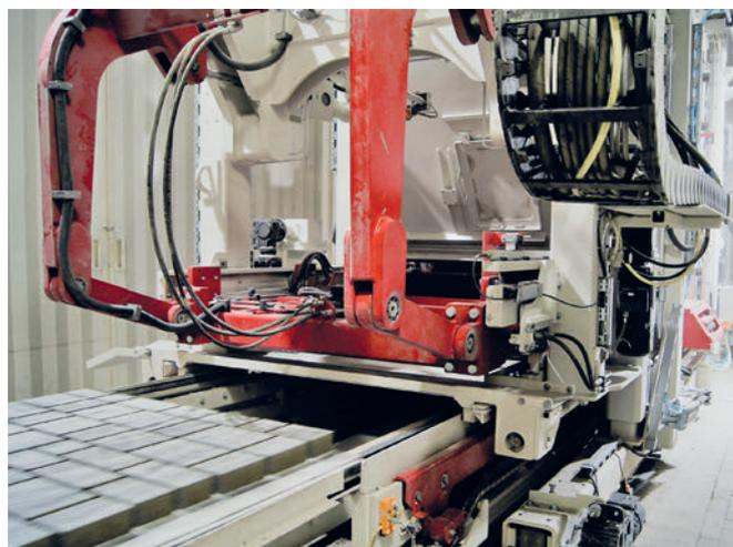
*Nouvelle génération de machines Hess: la machine à pavés RH 1500-4 MVA*
