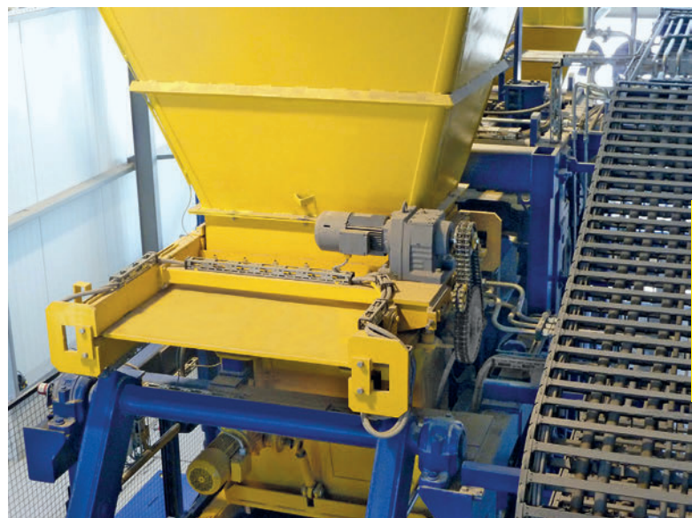
Version électrique pour les machines de production de blocs de la série L.
