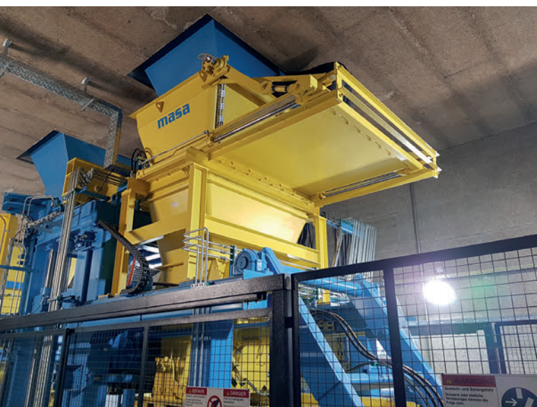
Version hydraulique pour les machines de production de blocs de la série XL.
