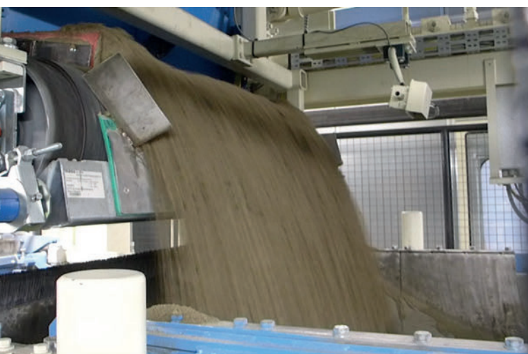
Remplissage du chariot de remplissage par le biais d'une bande doseuse.
