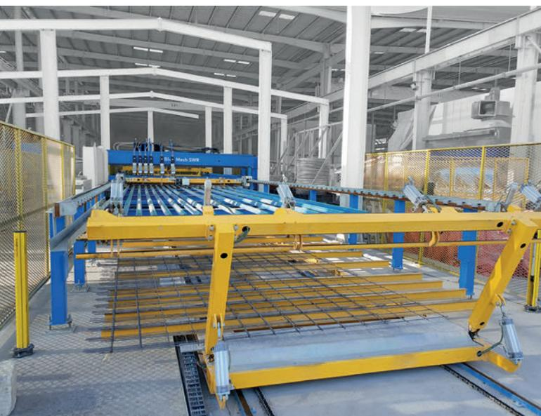
*L'installation nouvellement développée est conçue pour une flexibilité maximale dans la production de treillis.*
