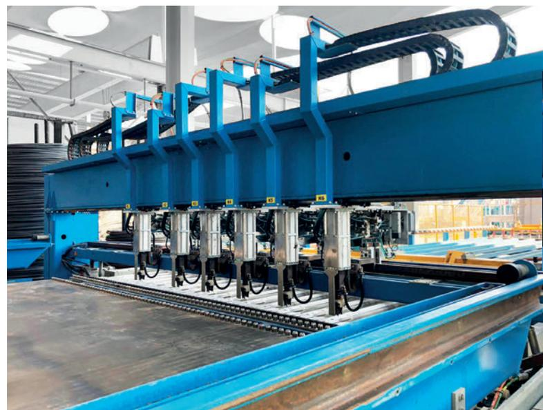
*Les treillis d'armature sont produits sur l'installation de soudage de treillis M-System BlueMesh® avec un ajustement exact et juste à temps.*
