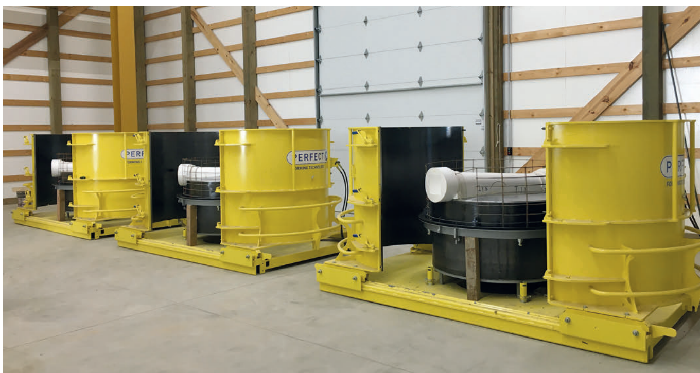
Los moldes equipados con canales de EPS y reforzados con acero están preparados para el llenado con hormigón autocompactante
