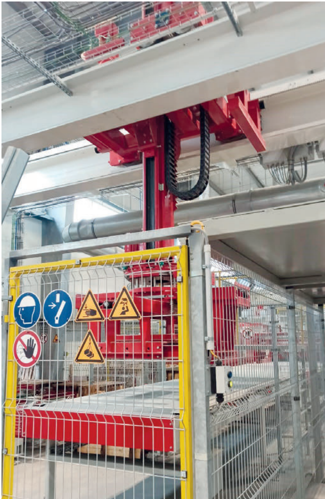
Apiladora de planchas con carro de desplazamiento con pinza mecánica de 4 lados
