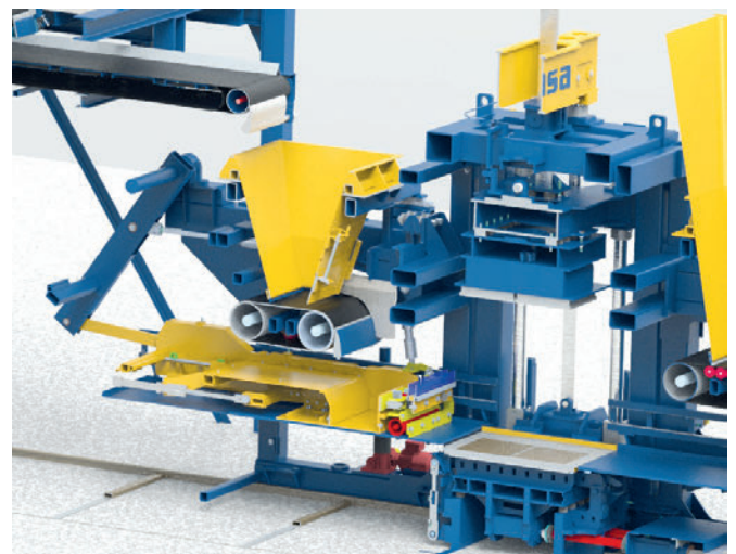
Carro de llenado del hormigón bicapa con chapa del suelo hidráulica.
