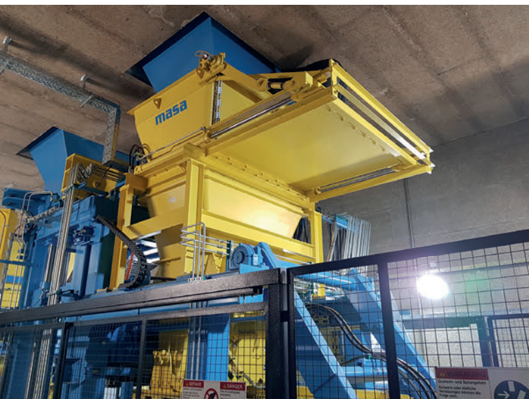
Versión hidráulica para las máquinas bloqueras de la serie XL.
