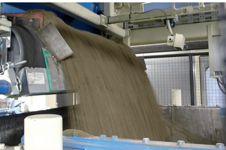
Llenado del carro con cinta dosificadora.
