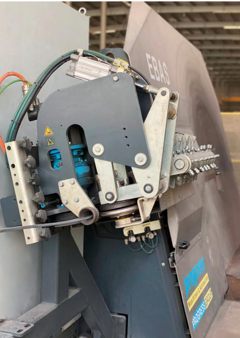
Der Bügelbiegeautomat EBA S 16 von Progress Maschinen & Automation ist erfolgreich bei der Bearbeitung von Betonstahl im Einsatz.
