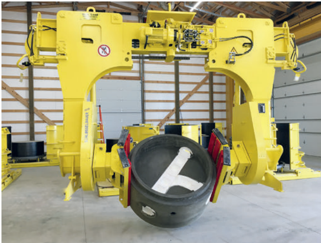
Für sicheres Entschalen und Wenden der Bauteile setzt Precast Supply einen hydraulischen Wendegreifer ein.
