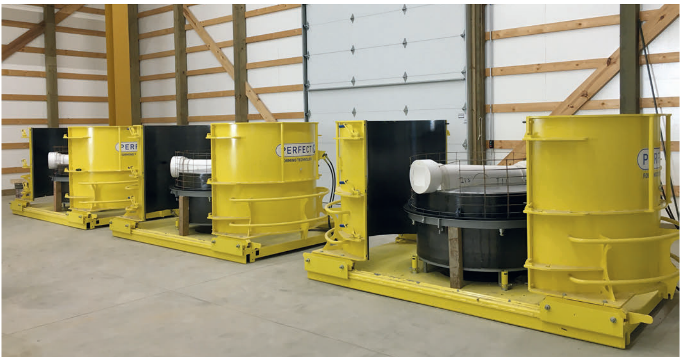
Die mit EPS-Gerinne und Stahlbewehrung gerüsteten Gießformen stehen bereit für die Befüllung mit Selbstverdichtendem Beton.
