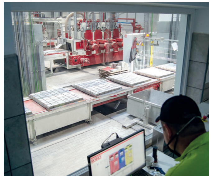
Blick aus der Steuerkabine auf die Trockenseite, im Hintergrund befindet sich die Curling-Maschine von SR Schindler
