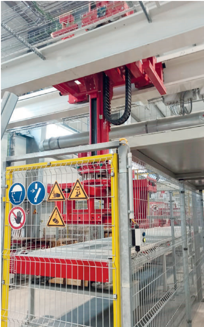
Lagenstapler mit Fahrwagen mit motorischer 4-Seiten-Zange
