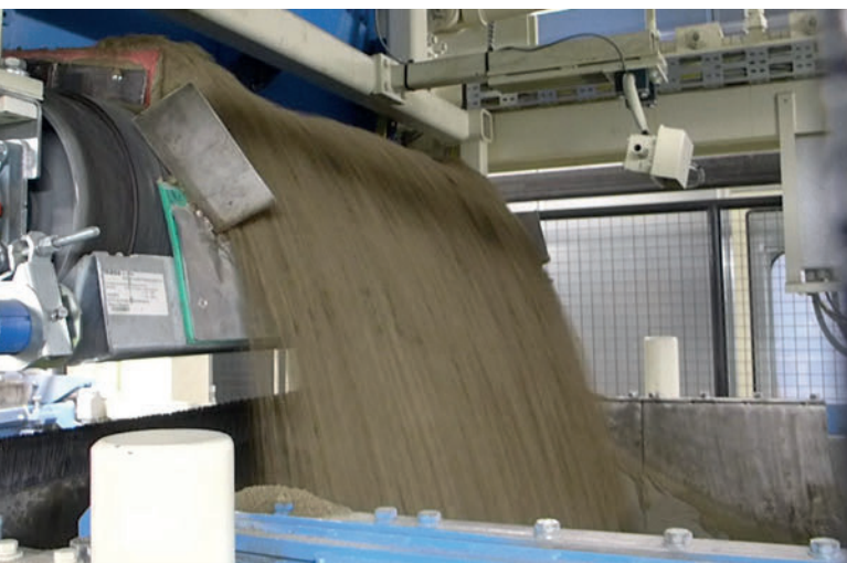
Füllwagenbefüllung via Dosierband
