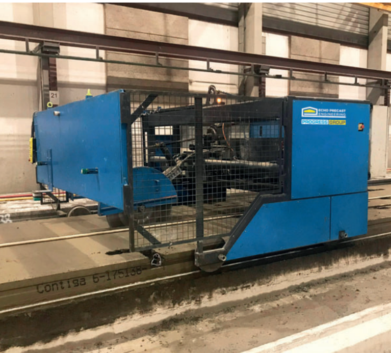
Пила по бетонной смеси FCS выполняет продольные разрезы в свежеложенном бетоне
