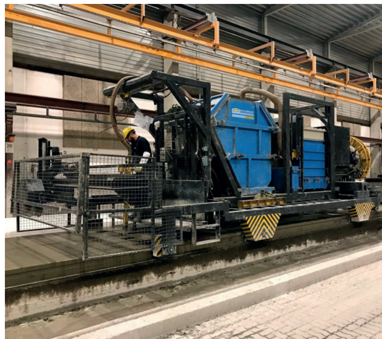
Бетоноотсасывающий агрегат оснащен всасывающим патрубком и сопряженным насосом, который перекачивает бетонную смесь по шлангу в контейнер для отходов. На передней панели станка расположен дополнительный модуль «двойного реза»
