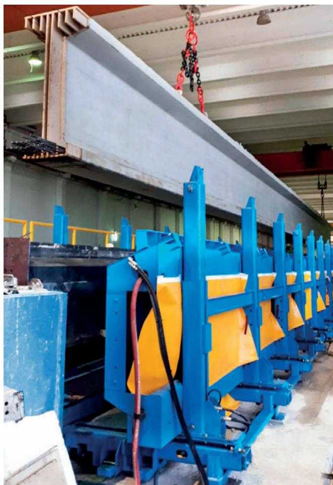
Извлечение бетонной балки из регулируемой опалубки с индивидуально настраиваемыми секциями
