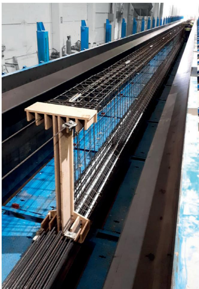
Очень гибкая и автоматическая опалубка для производства балок была специально разработана для компании Hormipresa
