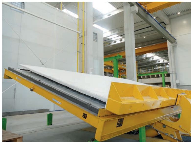
Кантователь снабжен опорной балкой, которая поддерживает готовый элемент стеновой панели в процессе наклона и облегчает распалубку
