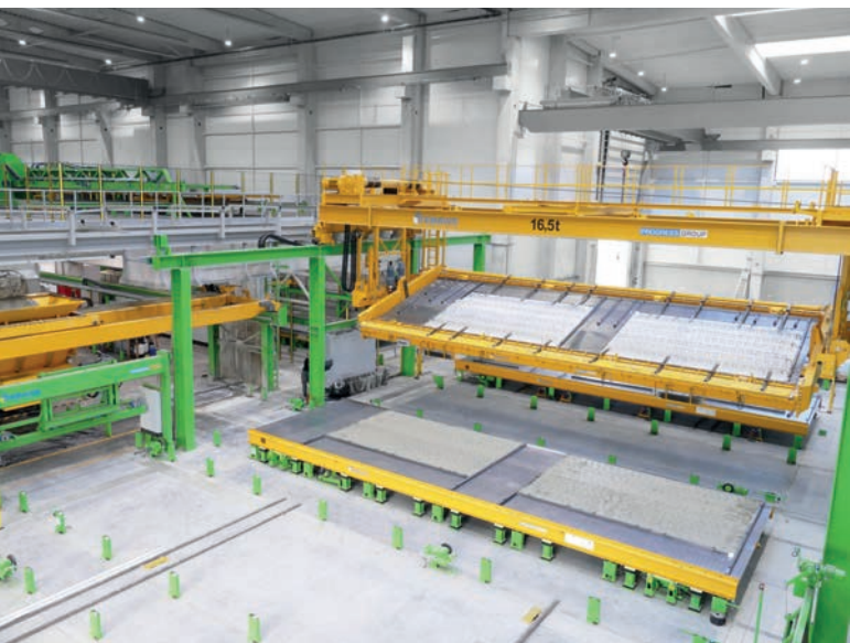
Вид на новый производственный цех Pekabex в Гданьске с бетонораздатчиком, автоматическим поворотным устройством и арматурным участком на втором уровне
