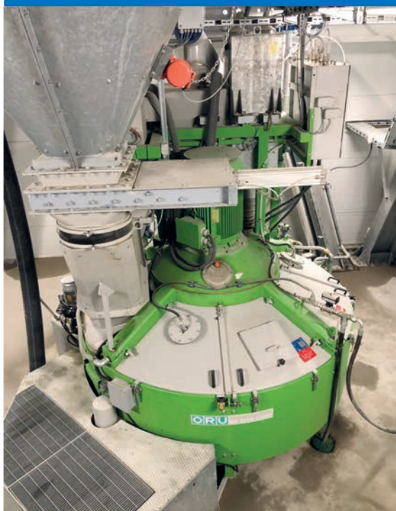
БСУ оборудована планетарным смесителем ORU MS 2.250 / 1.500S
