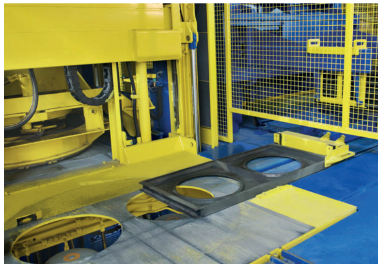
Автоматическая подача опорной муфты на производственную установку
