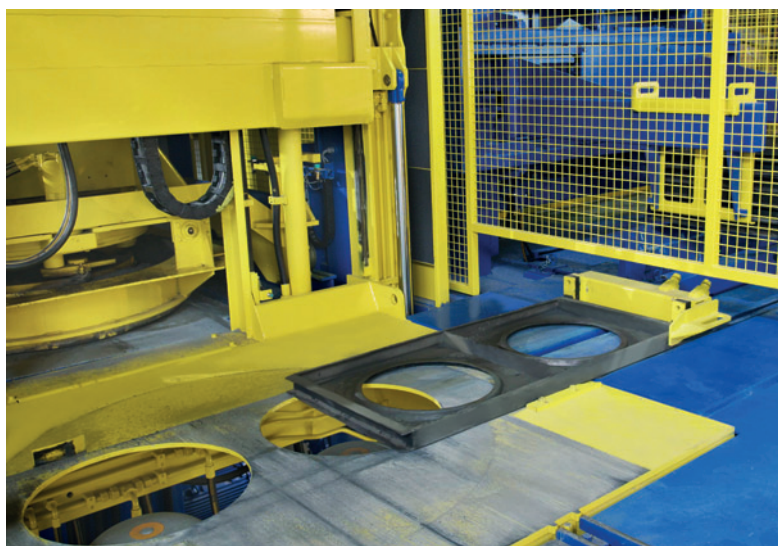
Automatyczne wprowadzanie podkładu do maszyny produkcyjnej.
