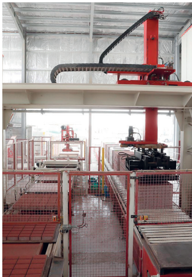
Urządzenie pakietujące Servo 700 z przenośnikiem skokowym i przenośnikiem płytkowym pakietów wyrobów.
