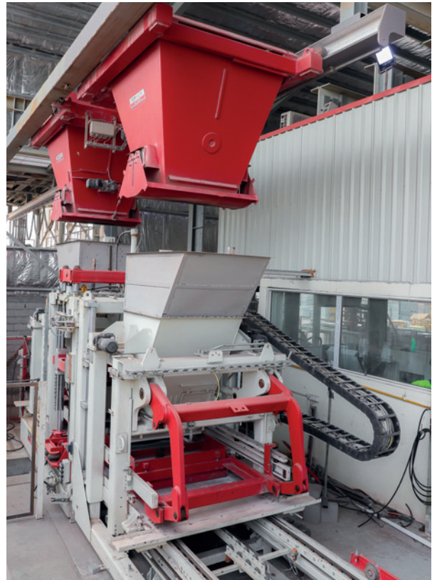
Wibroprasa RH 1500-3 z systemem dwóch wózków betonu poruszających się po estakadzie.
