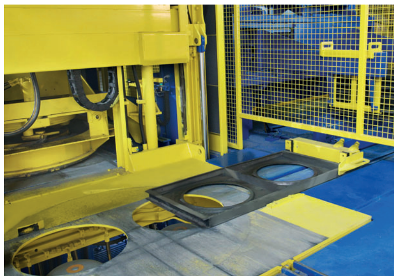
Inserimento automatico del fondello inferiore nell'impianto di produzione.
