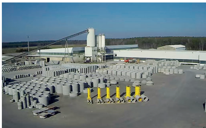
Presentazione dei tubi combinati in calcestruzzo e materiale sintetico Perfect Pipe presso lo stabilimento produttivo di Grafe Beton a Stölpchen, vicino Dresda, Germania.
