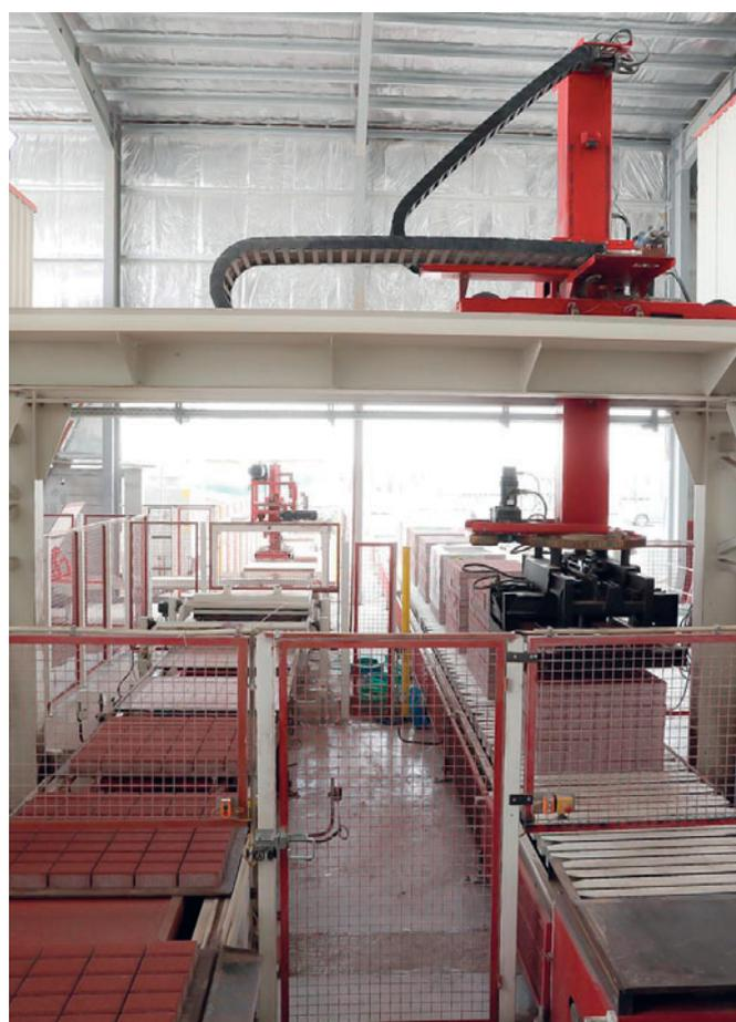
Impacchettatrice Servo 700 con trasportatore a corsa libera e trasportatore a traversine
