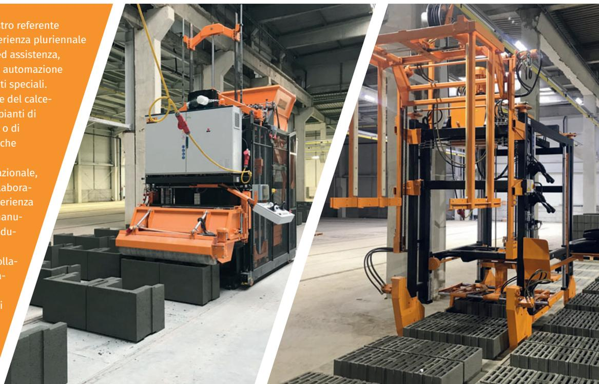
Per quanto riguarda la parte tecnica, l'Hess Group fornisce macchine che, a seconda del modello scelto, sono in grado di produrre manufatti da 25 mm a 500 mm di altezza. Il cliente ha la possibilità di produrre una vasta gamma di prodotti di calcestruzzo d'altissima qualità che vanno dalle versioni piatte a quello spesse. Nel frattempo i clienti sanno che possono rivolgersi all'Hess Group se in futuro intendevano pianificare all'insegna della flessibilità.
