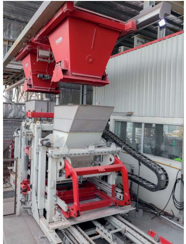
Máquina de producción de bloques RH 1500-3 con cuba aérea doble
