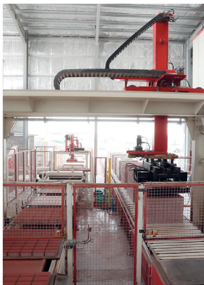
Empaquetadora Servo 700 con sistema de transporte de canguro y pista de almas
