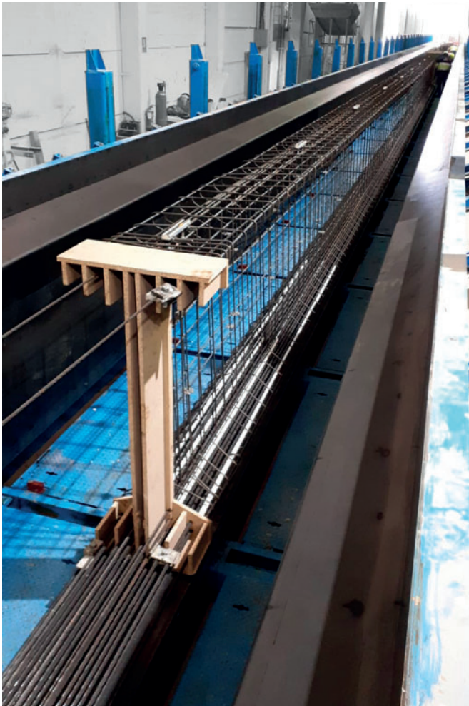
El encofrado automático y muy flexible para fabricar vigas ha sido diseñado especialmente para Hormipresa
