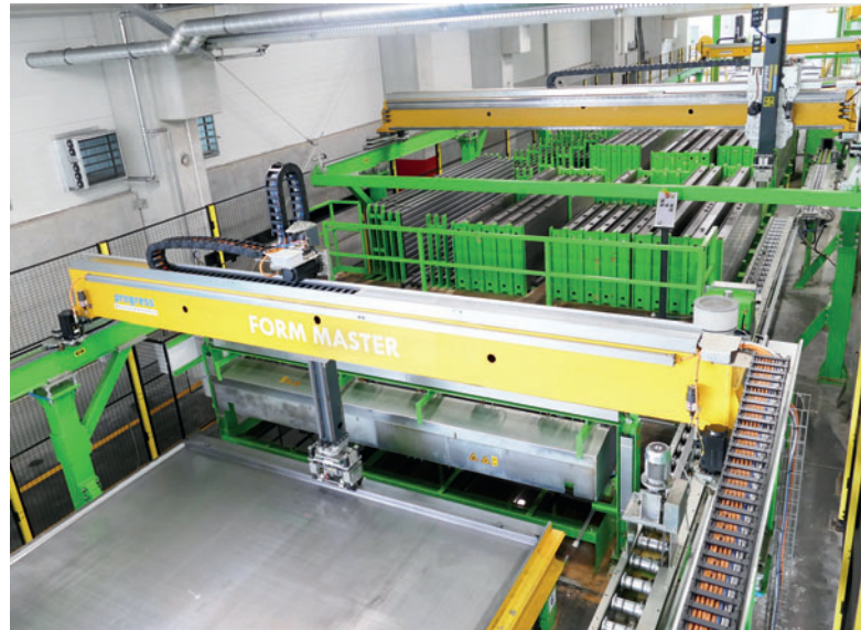
Ein Robotersystem bestehend aus Lager-, Entschal- und Schalungsroboter führt sämtliche Schritte des Schalungsprozesses vollautomatisch aus. Mit Hilfe eines Greifwerkzeuges werden auch Magnete für Elektrodosen positioniert sowie Konturen und weitere Informationen durch den Plotter aufgezeichnet.
