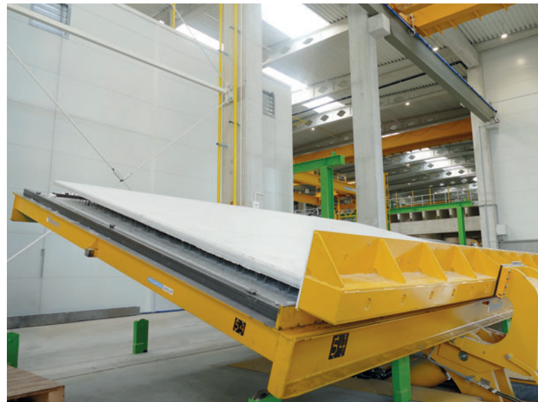
Die Kippeinrichtung ist mit einem Abstützbalken ausgestattet, der dem fertigen Wandelement während des Kippvorganges zusätzlichen Halt gibt und die Entnahme erleichtert.
