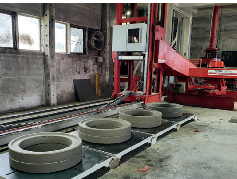
С помощью универсального робота-укладчика для опорных муфт компенсационные кольца размещаются на поддонах рядом с машиной
