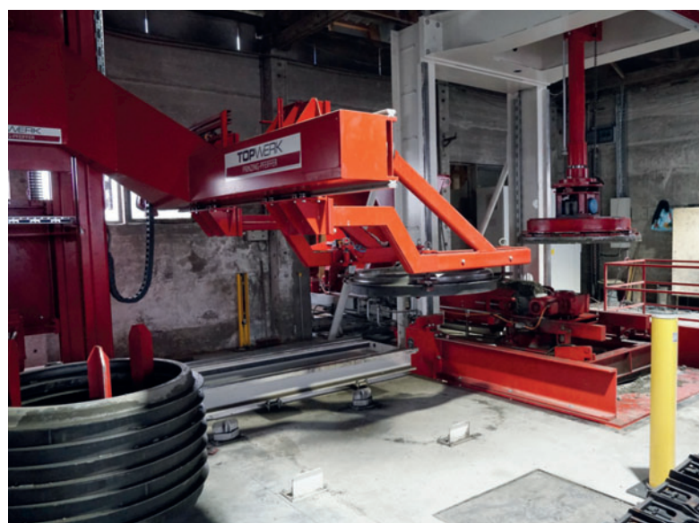
Робот-укладчик для опорных муфт со штабелем муфт
