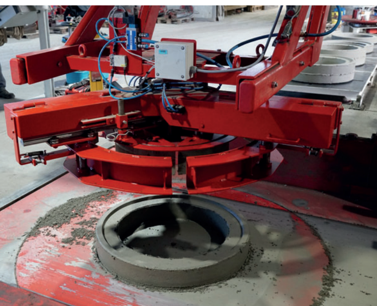
Навесной захват для транспортировки компенсационных колец
