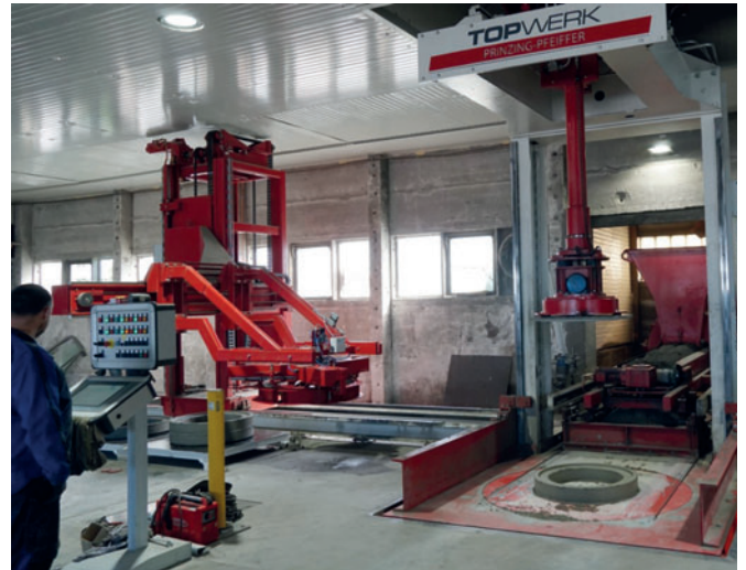
Производство компенсационных колец на установке Tornado
