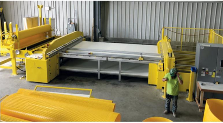
*Полностью автоматическая система сварки футеровок из полиэтилена высокой плотности Schlüsselbauer Technology позволяет изготавливать футеровочные цилиндры диаметром от DN 300 до DN 1500 при макс. длине трубы 3 м*
