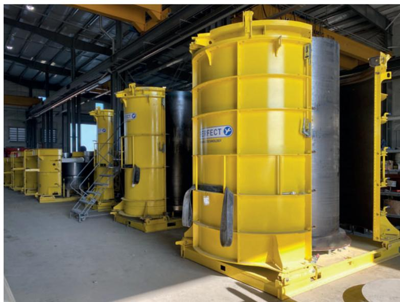
Система формования Perfect Forming Technology для переработки самоуплотняющегося бетона является ключевым элементом производственного процесса Perfect Pipe
