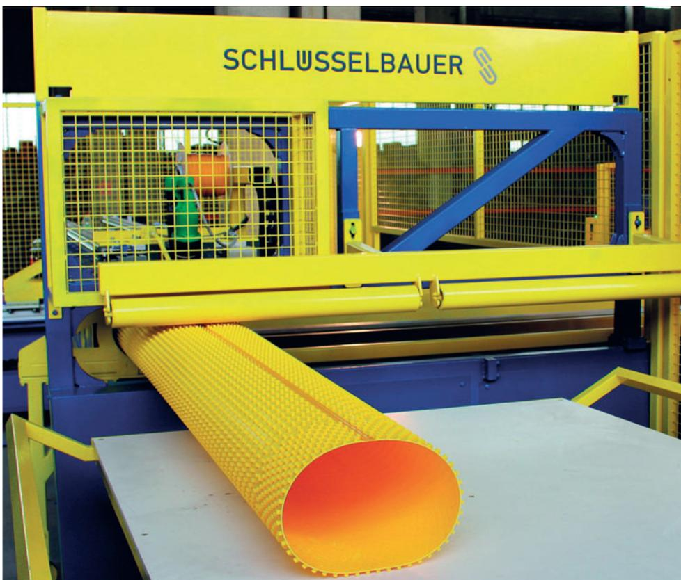
*После этапа сварки и охлаждения цилиндр извлекается из машины и сразу же готов к следующему этапу производства*
