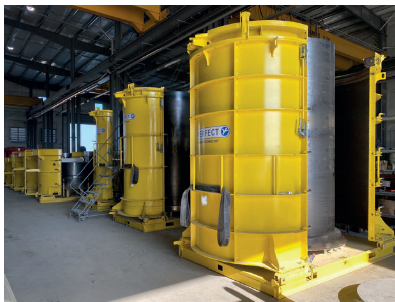
Perfect Forming Technology – system produkcji z zastosowaniem betonu samozagęszczalnego – jest kluczowym elementem wytwarzania rur Perfect Pipe.
