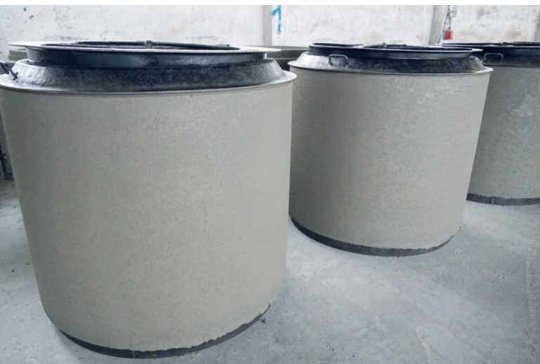
Wyprodukowane pierścienie wyrównujące na podkładach, gotowe do odtransportowania ze stanowiska wibroprasowania.
