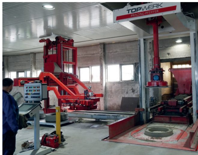
System Tornado, produkcja pierścieni wyrównujących.
