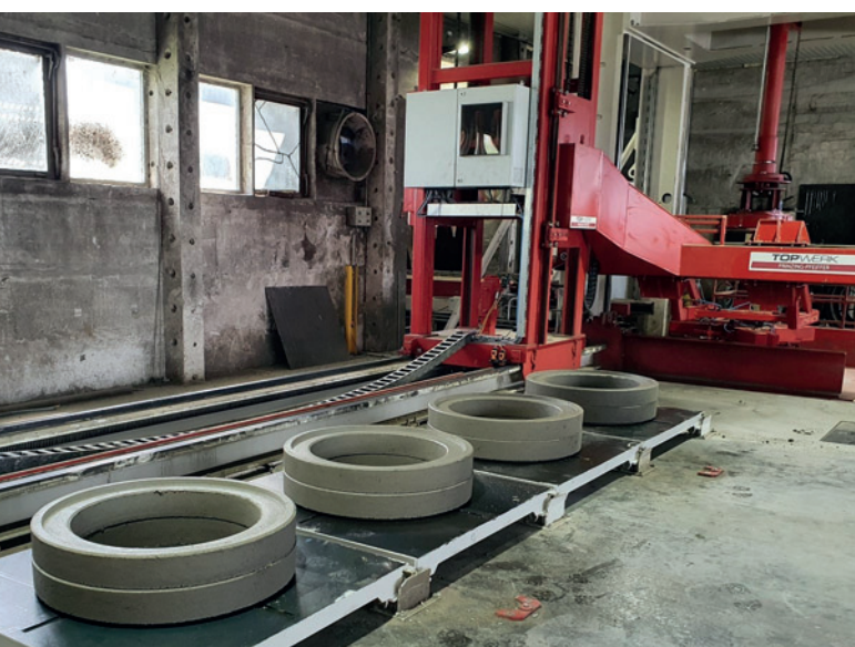
Uniwersalny robot, podający pierścienie dolne, przekłada pierścienie wyrównujące ze stanowiska produkcyjnego obok maszyny na podkłady.
