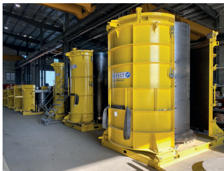
Il sistema di stampaggio Perfect Forming Technology per la lavorazione del calcestruzzo autocompattante è un elemento chiave del processo produttivo di Perfect Pipe.
