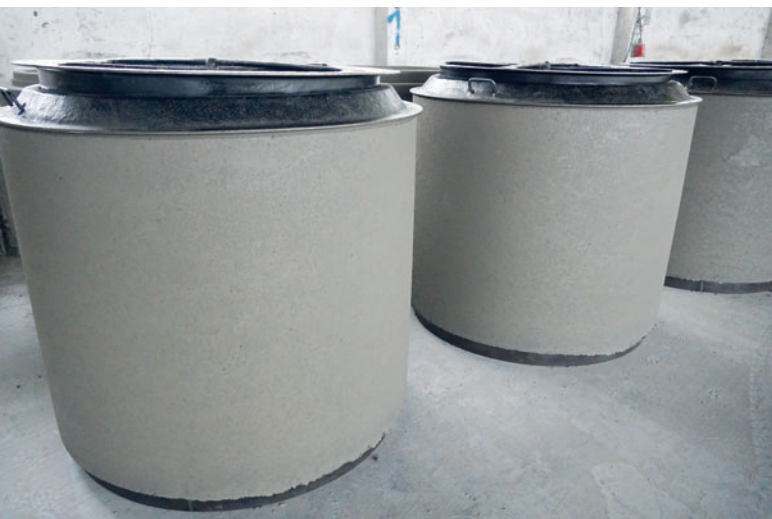
Anelli per pozzetti appena prodotti nell'area di maturazione
