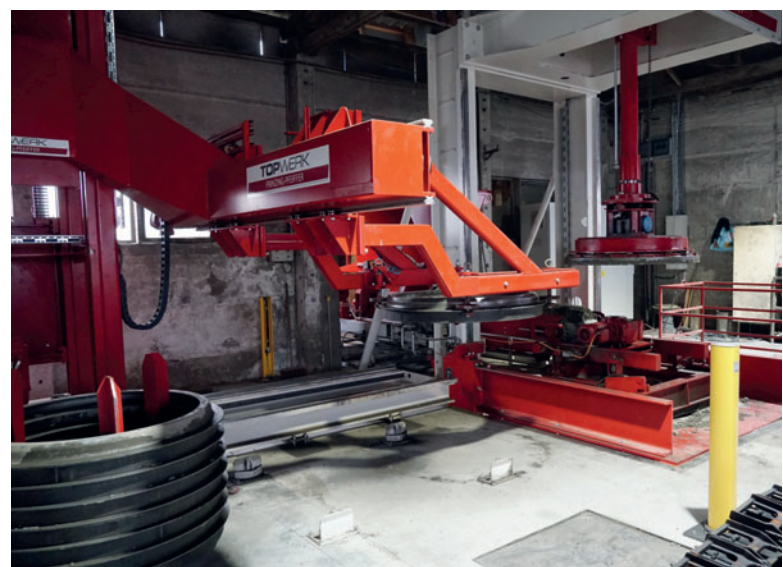
Il robot d'inserimento pallet inferiori con pallet inferiori impilati
