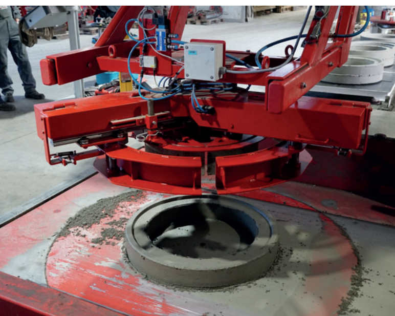
Dispositivo di presa applicato per il trasporto degli anelli di compensazione
