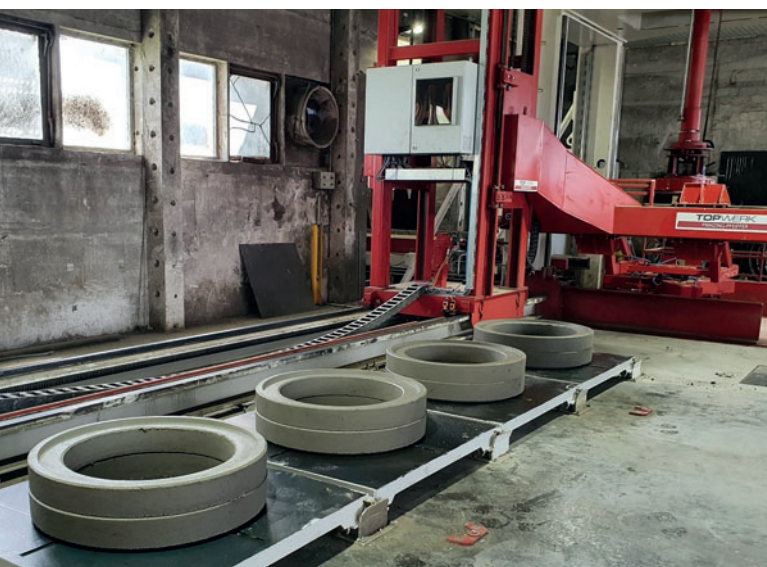
Con un robot di inserimento universale per pallet inferiori gli anelli di compensazione vengono depositati sui pallet dal punto di produzione vicino alla macchina
