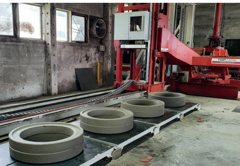
Avec le robot d'insertion universel pour les rondelles de base, les anneaux de compensation sont placés sur des palettes provenant de la zone de production à côté de la machine
