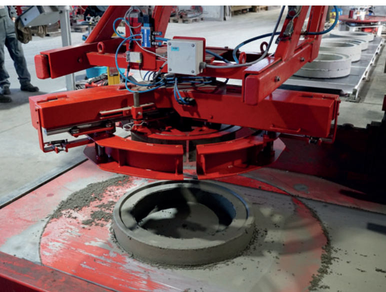
Pince attachée pour le transport des anneaux de compensation
