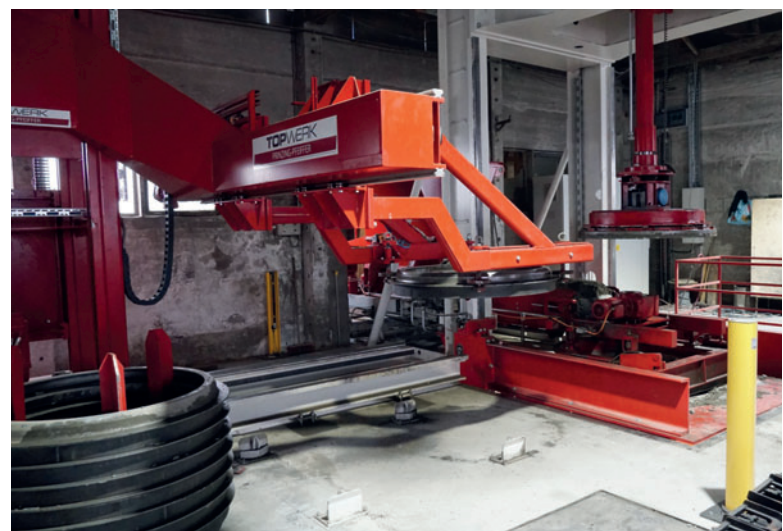
Le robot d'insertion avec des rondelles de base empilées
