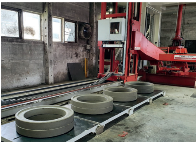
Con el robot de colocación universal para manguitos inferiores, los anillos de compensación se colocan desde el área de producción junto a la máquina sobre paletas
