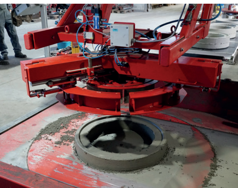
Pinza acoplada para el transporte de los anillos de compensación
