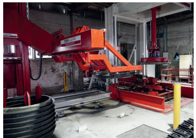
Robot de colocación con manguitos inferiores apilados
