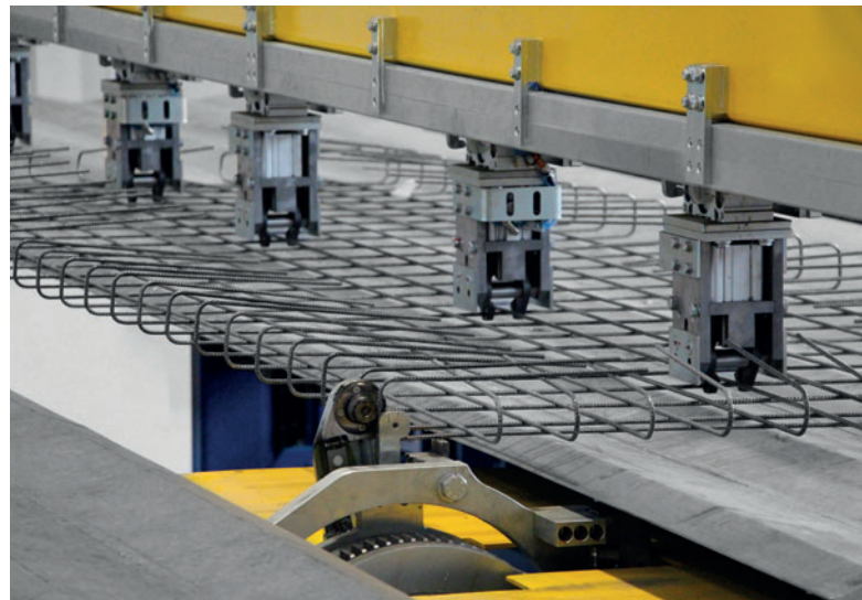
Die beweglichen und rotierbaren Einzelbiegemaschinen sorgen für volle Flexibilität.
