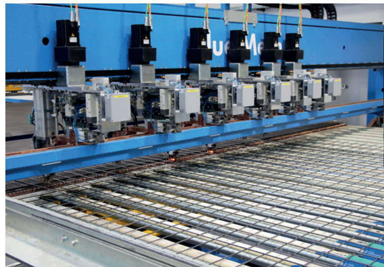
Die einzelnen Stahldrähte werden mittels Progress-Punktschweißverfahren in beliebigem Abstand verschweißt.
