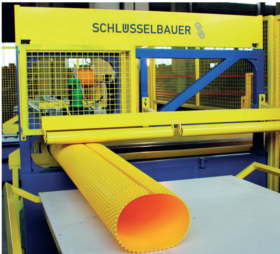
Nach der Schweißung und Abkühlphase wird der Liner-Zylinder aus der Maschine ausgestoßen und steht für den nächsten Produktionsschritt bereit.
