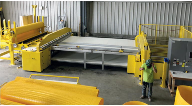
Die vollautomatische HDPE-Liner-Schweißanlage von Schlüsselbauer Technology liefert Liner-Zylinder von DN 300 bis DN 1500 für max. Rohrbaulänge 3 m.
