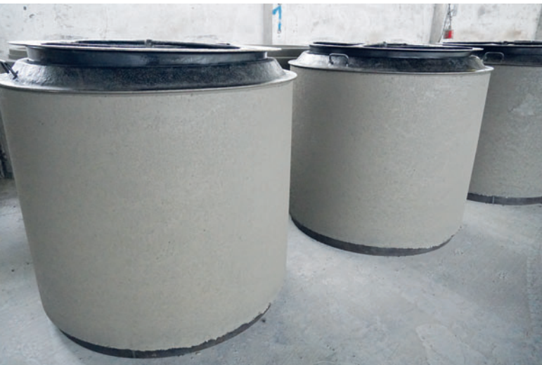
Frisch produzierte Schachtringe im Aushärtbereich
