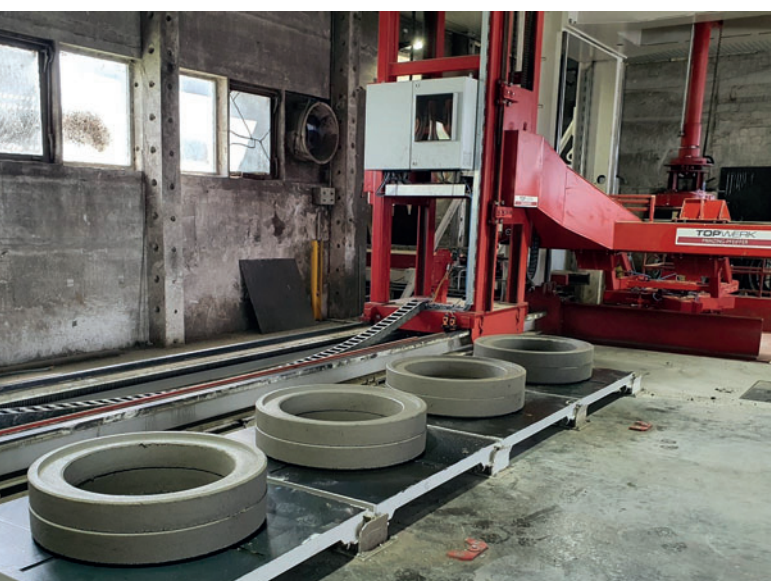
Mit dem universellen Einlegeroboter für Untermuffen werden die Ausgleichringe von der Produktionsstelle neben der Maschine auf Paletten abgestellt.
