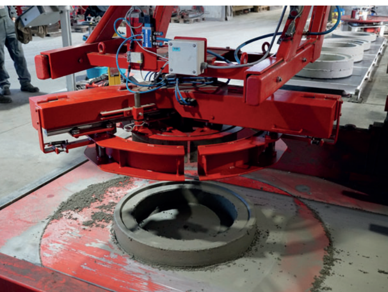
Angebauter Greifer für den Transport der Ausgleichsringe
