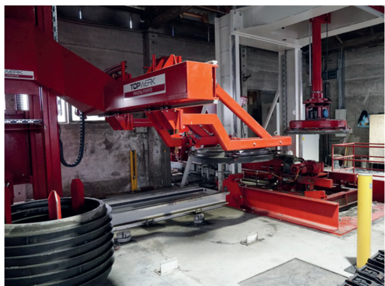
Der Untermuffen-Einlegeroboter mit gestapelten Untermuffen
