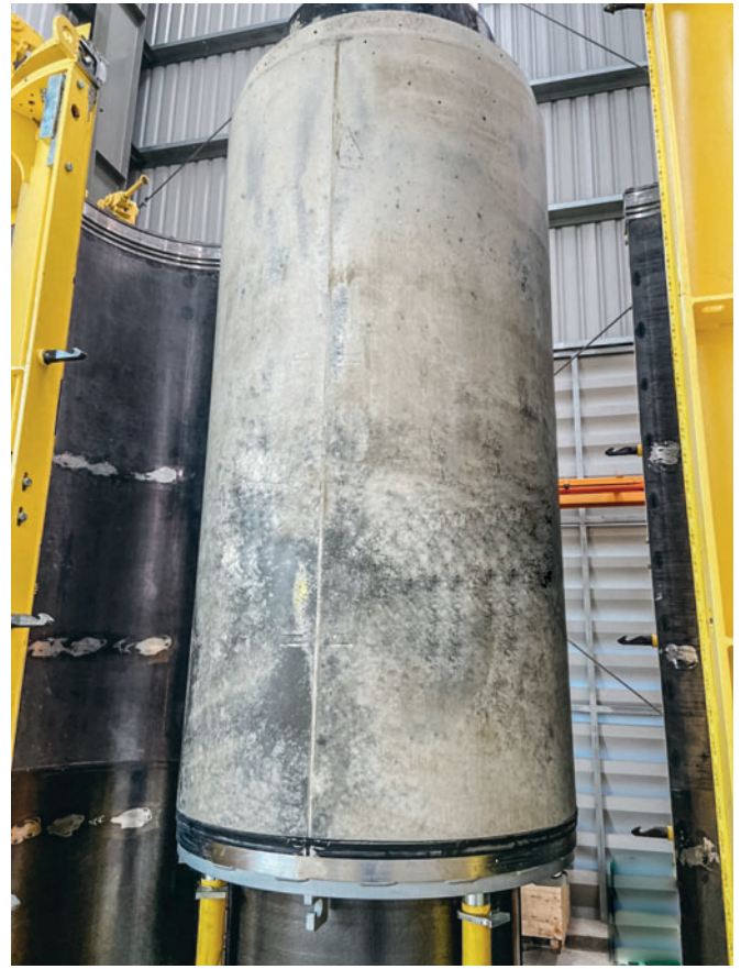
Труба для микротоннелирования Perfect Jacking Pipe спустя несколько часов твердения в опалубке
