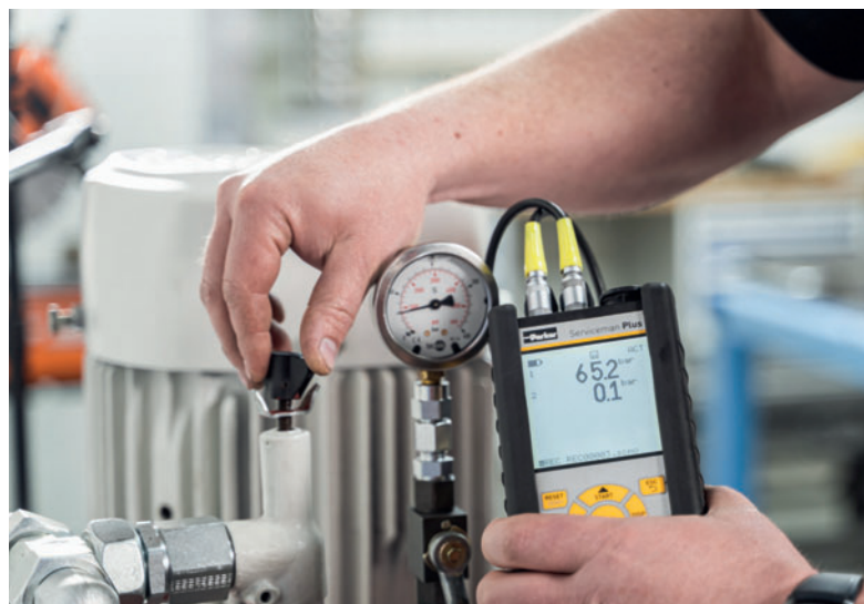
Проверка давления в системе
