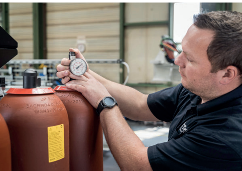
Проверка баллонного гидроаккумулятора на предмет стабильной производительности и безопасного функционирования
