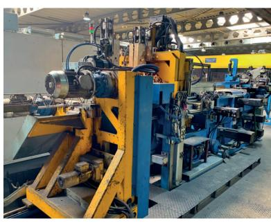
На сварочной установке VGA Versa изготавливаются решетчатые балки для циркуляционной линии по выпуску перекрытий по схеме «точно в срок» с возможностью бесступенчатой регулировки высоты и автоматической замены диаметра проволоки верхнего пояса
