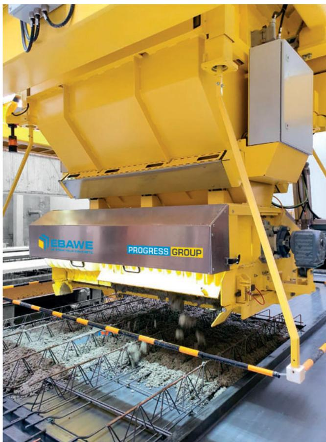
Новый бетонораздатчик работает быстро и точно при производстве двойных стеновых панелей с теплоизоляцией и без нее, плит перекрытия и сплошных стеновых панелей высокого качества
