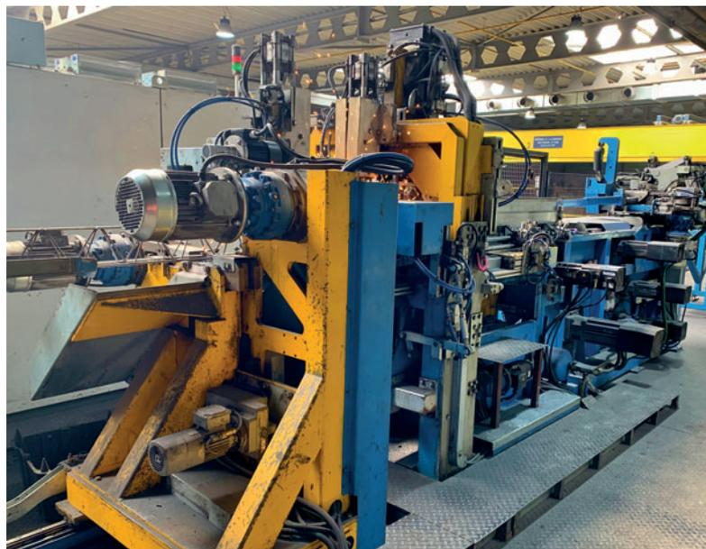
*L'impianto per la produzione di tralicci elettrosaldati VGA Versa produce just-in-time tralicci per l'impianto a carosello per i solai a lastra con una regolazione automatica in altezza e dispone di un cambio automatizzato del diametro dei nastri del filo superiore.*
