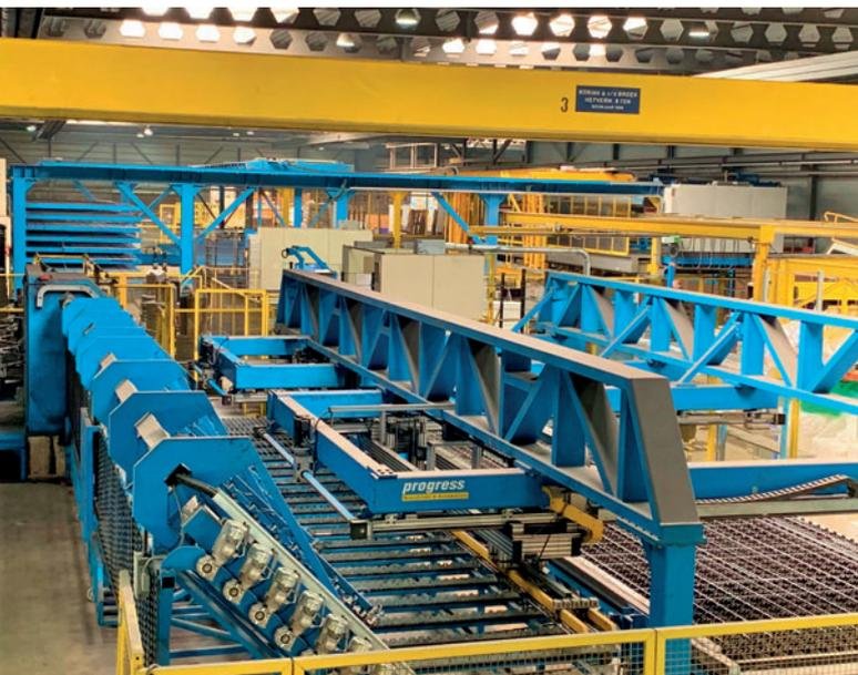
*L'impianto di produzione di reti elettrosaldate M-System, concepita per una produzione flessibile, si inserisce bene nel concetto globale..*
