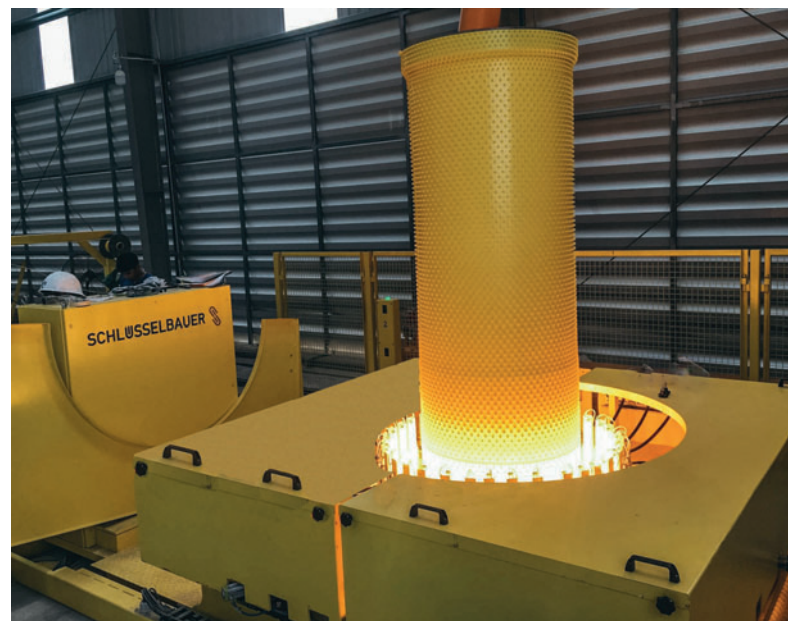
La trasformazione termoplastica dei cilindri di rivestimento è un passaggio fondamentale nella produzione di Perfect Pipe.
