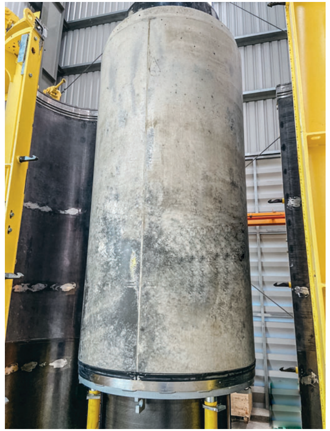
Perfect Jacking Pipe - indurito in cassaforma dopo poche ore nello stampo
