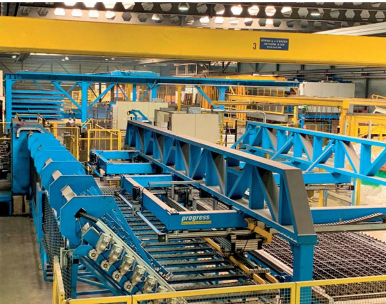
*L'installation de soudage de treillis M-System a été développée en vue d'une production la plus flexible possible et s'intègre donc de manière optimale dans le concept global.*
