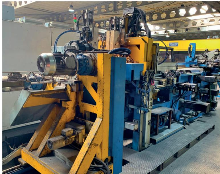
*La soudeuse de raidisseurs VGA Versa produit les raidisseurs en juste-à-temps pour le carrousel à palettes des prédalles avec changement de hauteur automatique et dispose d'un changement automatisé du diamètre du fil de la membrure supérieure.*
