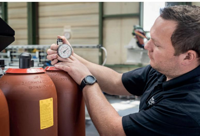
Test de l'accumulateur à vessie pour une performance constante et un fonctionnement sûr
