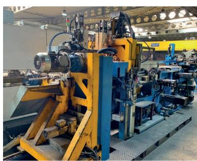
La soldadora de armaduras de celosía VGA Versa fabrica armaduras de celosía para la instalación a circulación de bandejas en el momento preciso con alturas graduables y cuenta con un sistema automático de cambio de diámetro de alambres para el cordón superior
