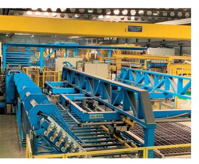
La instalación de soldadura de mallas M-System ha sido desarrollada para una producción lo más flexible posible y de este modo se integra muy bien en el concepto global
