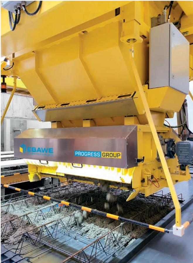
*El nuevo distribuidor de hormigón funciona de forma rápida y precisa en la producción de muros dobles con y sin aislamiento, prelosas armadas y muros macizos con una calidad muy elevada.*
