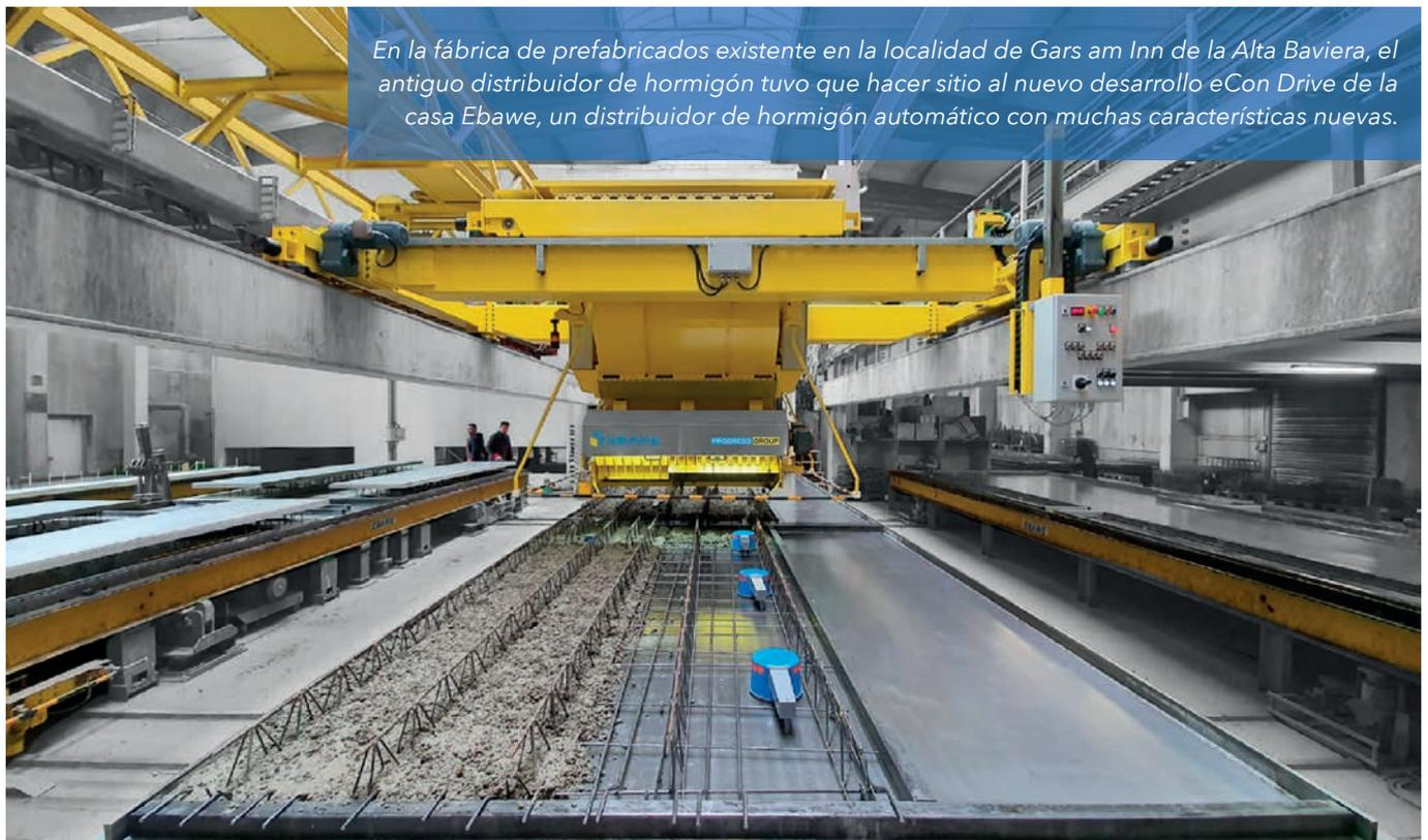
*En la fábrica de prefabricados existente en la localidad de Gars am Inn de la Alta Baviera, el antiguo distribuidor de hormigón tuvo que hacer sitio al nuevo desarrollo eCon Drive de la casa Ebawe, un distribuidor de hormigón automático con muchas características nuevas.*
