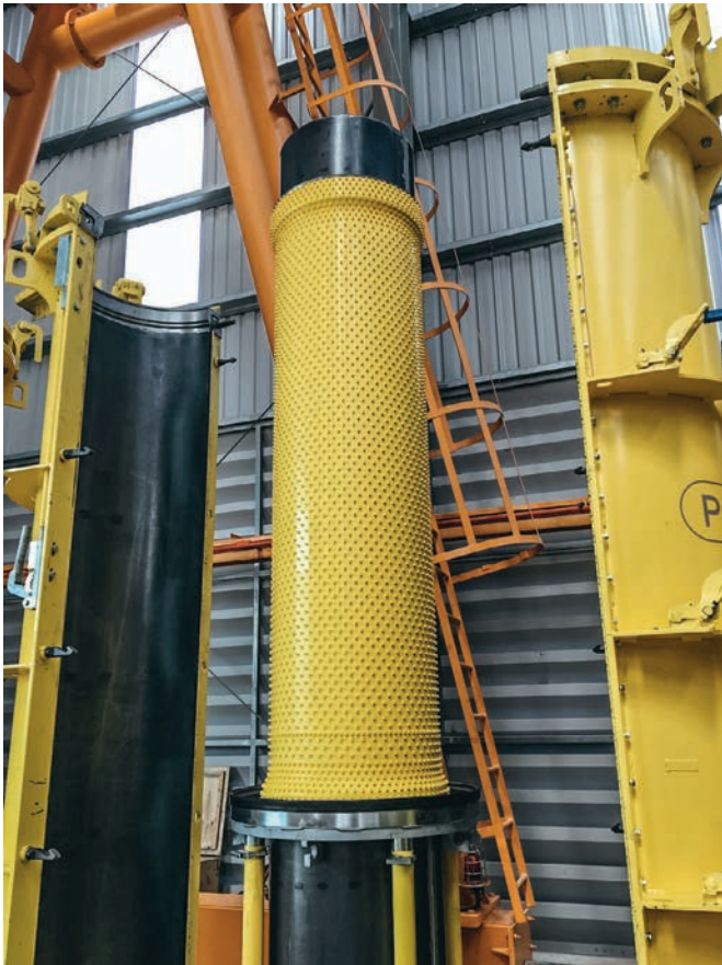
El liner Perfect se instala en el núcleo expansible.
