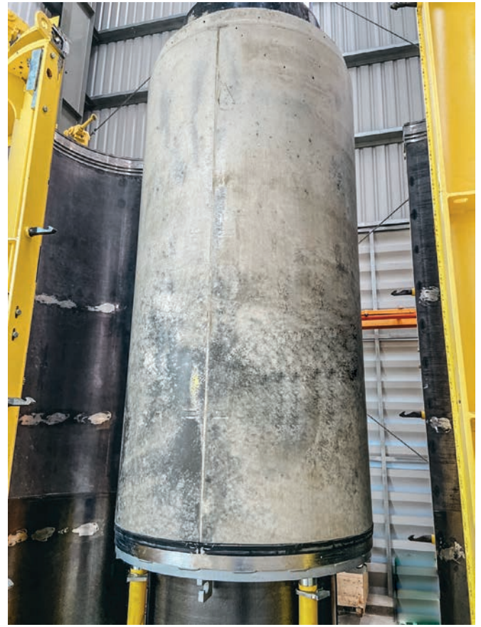
Perfect Jacking Pipe: endurecido en encofrado tras pocos segundos en el molde
