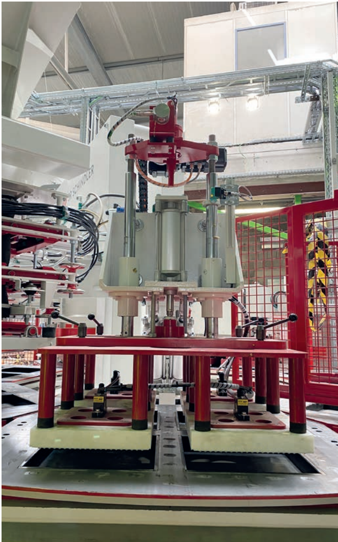
Fig. 4: Dosificador de manguera a la izquierda de la imagen y distribuidor de bicapa en primer plano
