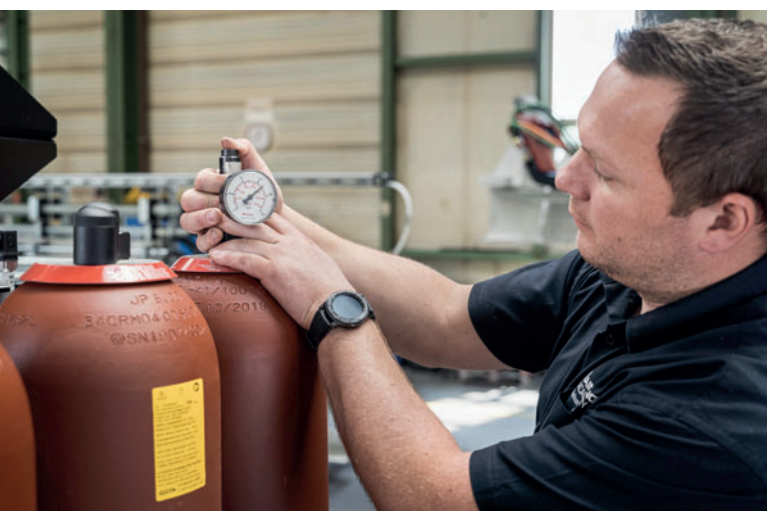
Comprobación del acumulador de vejiga para un rendimiento constante y un funcionamiento seguro
